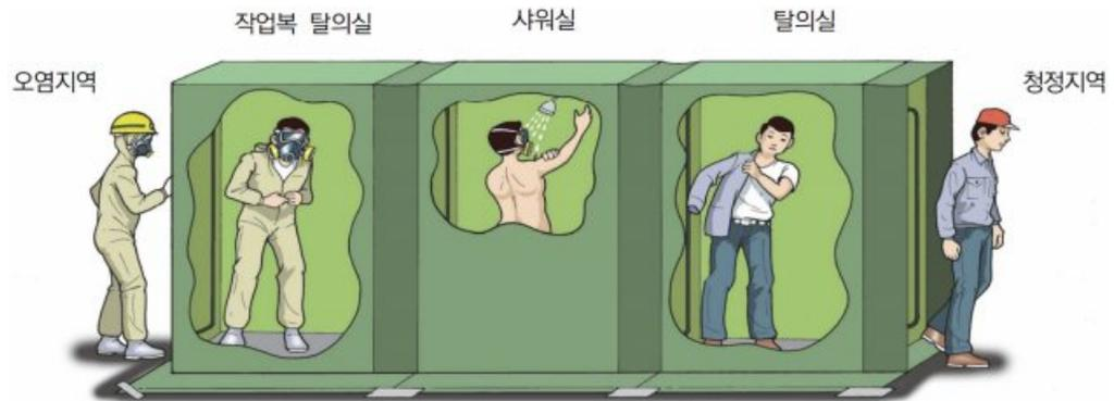
[그림 16] 위생설비 설치 및 사용
