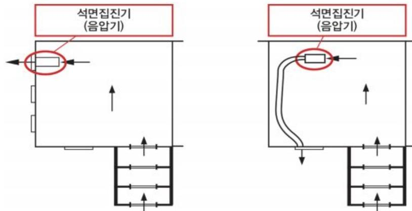
[그림 22] 밀폐작업장 내부 음압기 설치 예시
