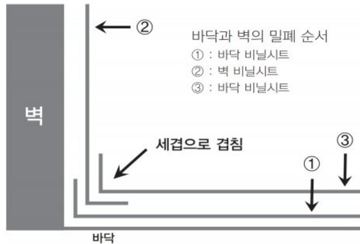
[그림 19] 비닐시트를 이용한 바닥과 벽의 밀폐순서
